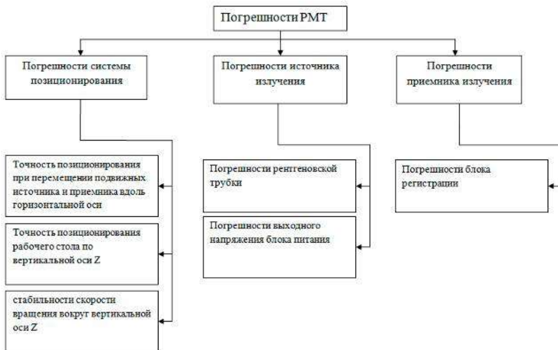
рис.1. а - схема погрешностей РМТ.
